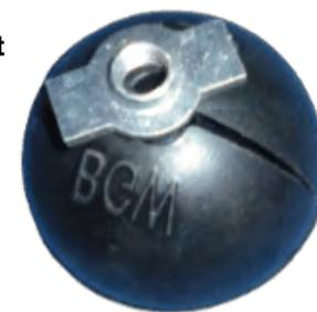
BGW-Aussparungskörper (ASK) schmal besteht aus Gummi und dient zum Fixieren von Kugelkopfanke in schmalen Bauteilen, an bzw. in der Schalung. In den Aussparungskörper wird entweder die Fixiermutter oder die Fixierschraube eingebaut. In das geöffnete Aussparungsmaul wird der KKA eingelegt. Beim Fixieren an der Schalung wird durch das Eindrehen bzw. beim Anziehen der Schraube das Maul des Aussparungskörpers verschlossen, um einen sicheren Sitz des KKA zu gewährleisten.
