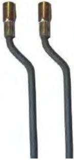
**BGW-Stabanker gekröpft** eignen sich durch ihre Bauform besonders für den Einbau in Sandwichplatten, bzw. in Bauteilen, dort wo die Randabstände sonst nicht eingehalten werden können. Beispiele: Schachtbauwerke und Garagen.
