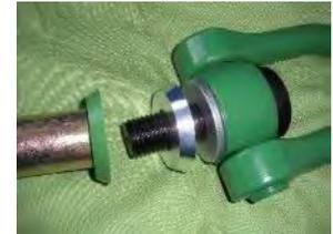
Zur Fixierung an Stahlschalungen werden **BGW-Haftmagnete** Typ HM4-D empfohlen. Der **BGW-Segmentanker-Abheber** stützt sich durch seine Geometrie auf die Flanken der Aussparung. Dadurch wird beim Schrägzug der Gewindezapfen entlastet und größere Transportsicherheit ermöglicht. **Achtung: Es darf nur ein Abhebemittel mit entsprechender Lastaufnahme verwendet werden!**
