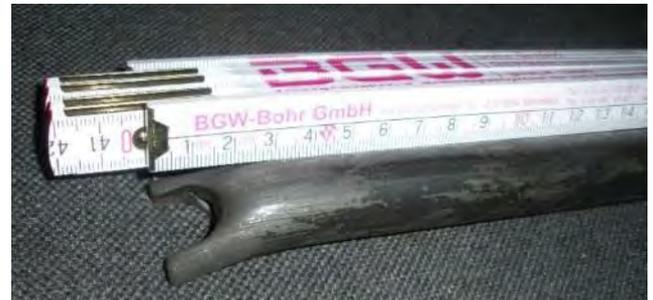
Länge der Rohrquerstrebe für Ankerbügel Laststufe 3,7t = Betonwandstärke - 74mm, für 4,5t - 75mm, für 5,8t - 78mm, für 8,5t - 82mm
