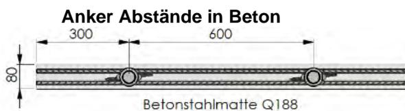
**BGW-Transportanker mit Flachbewehrungsanker FBA**
