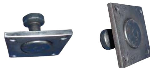
**BGW- Kugelkopf-Plattenanker - auch möglich mit Löchern im Plattenfuß, zum planebenen Aufschauben auf Holzbalken zum Transport, sowie beim Holz-Betonverbund als Kopfbolzen.**
