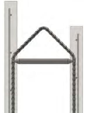
Der **BGW-Transportanker Fili14** mit Bewehrungsstahl  $\varnothing$  12 ist für eine axiale Last von 3,7 Tonnen, bei  $\varnothing$  14 für 4,5 Tonnen, bei  $\varnothing$  16 für 5,8 Tonnen und bei  $\varnothing$  20 für 8,5 Tonnen konzipiert.
