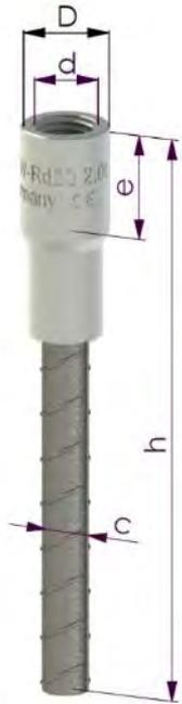
Gewindeanker können nicht nur als Transportanker sehr nützlich sein, sondern auch temporär zum Befestigen von Bauteilen, Stahlbauteilen wie Stützen, Streben, Schilder usw. eingesetzt werden.
