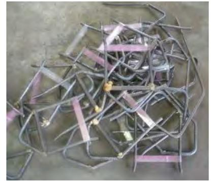
Dieser Transportanker ist speziell zum Einbau bei der Fertigung der Doppelwände mittels einer Wendestation geeignet.
