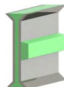
Schalleiste mit seitlich aufgesetzter magnetischer Vergussnut
