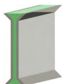
Schalleiste mit beidseitiger Fase – unten und oben-
