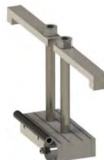
HM1 mit Auflager und außenliegendem Ablösehebel
