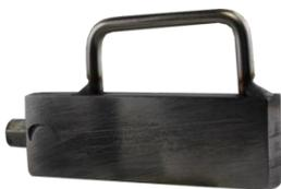
Wenn die magnetische Exzentrerspreize im Betonteil ist, kann man mit dem speziellen Inbusschlüssel die Spreize zurück auf öffnen drehen. Dazu das Spezialwerkzeug an der Magnetseite der Spreize anhaften lassen und mit dem Griff an diesem Werkzeug die lose Exzentrerspreize aus dem Bauteil entfernen.
