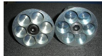
**Hinweis:** Jeder Magnet wird von uns in einer exakten Senkung Einzel eingesetzt, um damit zu verhindern, dass beim Bruch des Einzelmagnetes das komplette System stark geschwächt wird.
