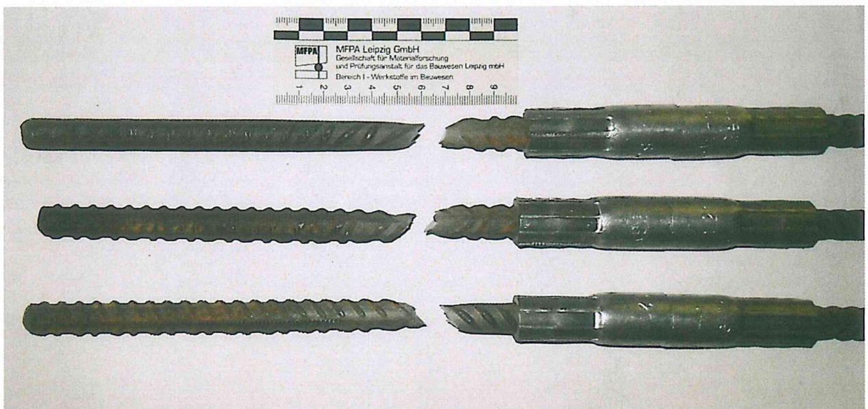
2-2: Bruchlage von Zugproben
