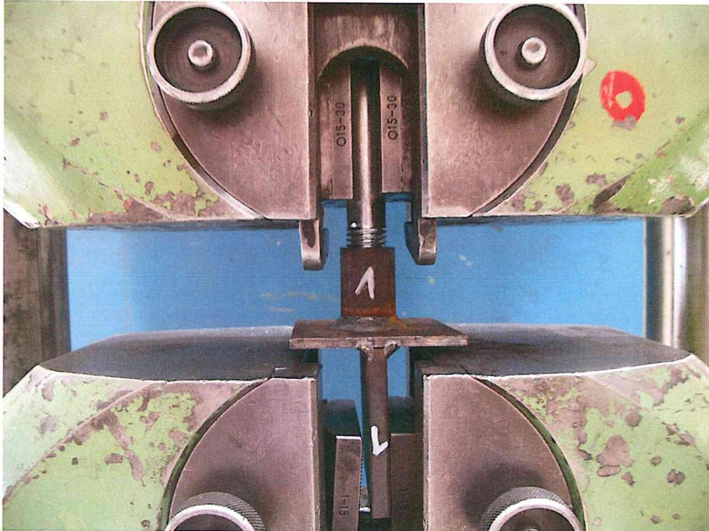
**Bild 2: Bruchlagen Flachstahllanker, Gewindebolzen M 24, Gewinde M 24; 2,5 t**
